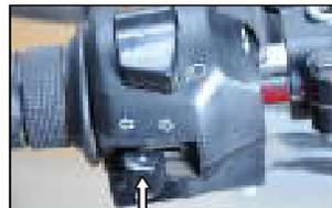
APAGADO (PRESIONE PARA APAGAR)
