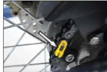
El extremo abierto del cierre del eslabón principal de la cadena debe hacer frente opuesto al sentido normal de rotación de la cadena como se muestra en la imagen.
