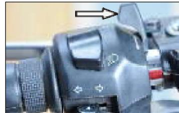
Aplique el obturador en condiciones de arranque frío mientras arranca la moto
